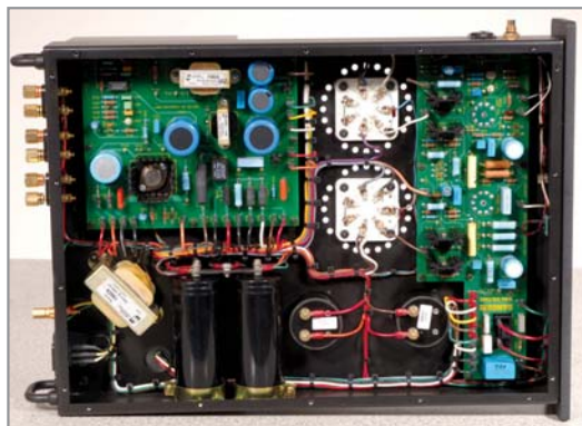
L'interno del Lamm 1.1; tolto il coperchio di fondo, troviamo: una circuizione lineare, semplice ma per nulla banale, un montaggio a regola d'arte ed un'ottimale scelta dei componenti. Sulla piastra più piccola è collocato il circuito relativo alla alimentazione ed ai servizi (quale ad esempio la temporizzazione), mentre sull'altra trovano posto la maggioranza dei componenti deputati all'amplificazione vera e propria.
