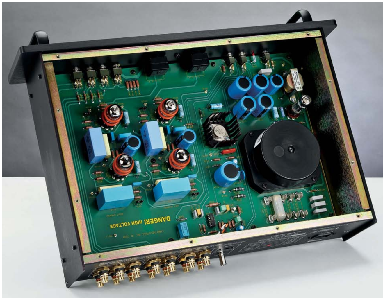
Ordinatissimo il layout, tutto appoggiato su un'unica scheda madre. Nella parte alta, incapsulati in due contenitori neri, ci sono gli ottimi potenziometri del volume TKD (sdoppiati per L&R e non motorizzati). Le quattro valvole smorzate con anelli in silicone sono due ECC82 e, quelle più in basso, due 6DJ8.
